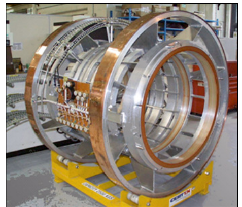
intérieur d'une bobine d'IRM source Siemens http://www.supraconductivite.fr/fr/index.php?p=applications-medical-irm-more
